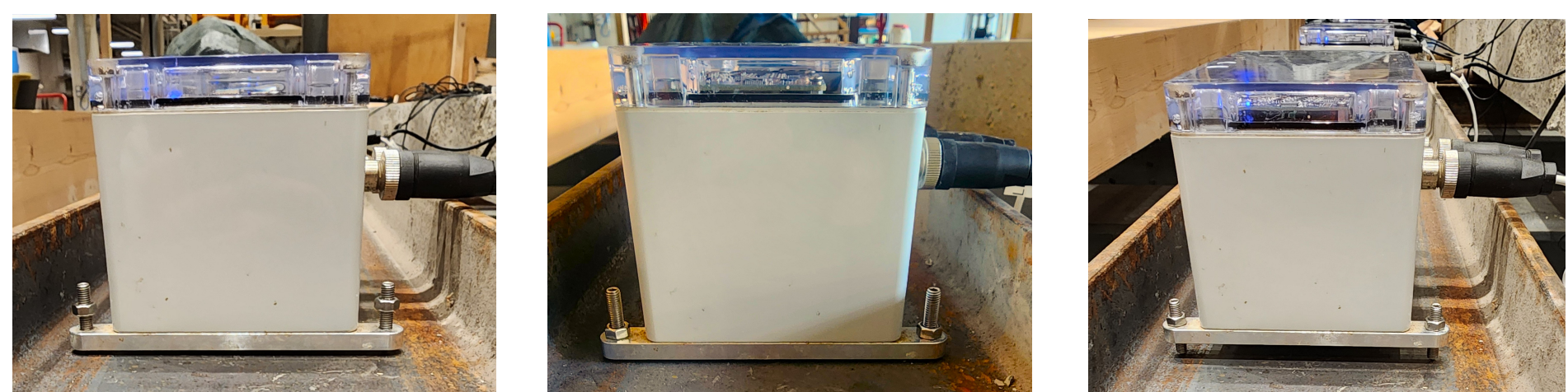
(L-D) Vissage desserré à 1 mm du support. (T-D) Vissage serré à 1 mm du support. (T-U) Vissage serré à 10 mm du support.
